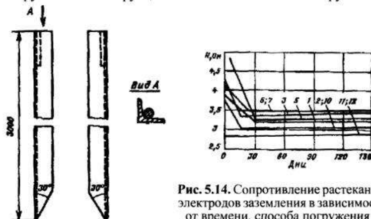
Рис. 5.13. Заземлитель из угловой стали
