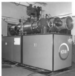
Виркаторы с индуктивным (слева) и емкостным (справа) накопителями энергии
