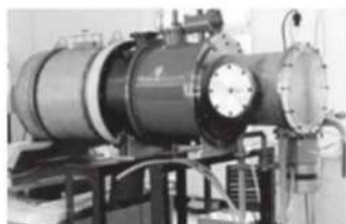
Виркаторы с индуктивным (слева) и емкостным (справа) накопителями энергии
