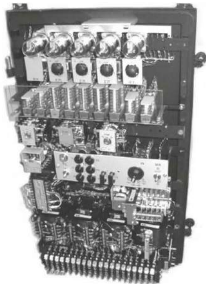
Рис. 5.14. Реле дистанционной защиты линий LZ31
