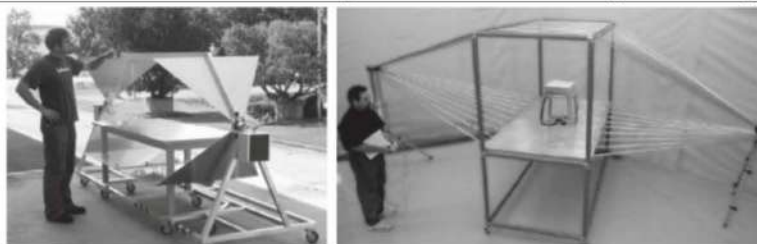
Рис. 6.9. Компактные стенды для испытания электронной аппаратуры на устойчивость к ЭМИЗ. а- Montena Technology, б - Applied Physical Electronics
