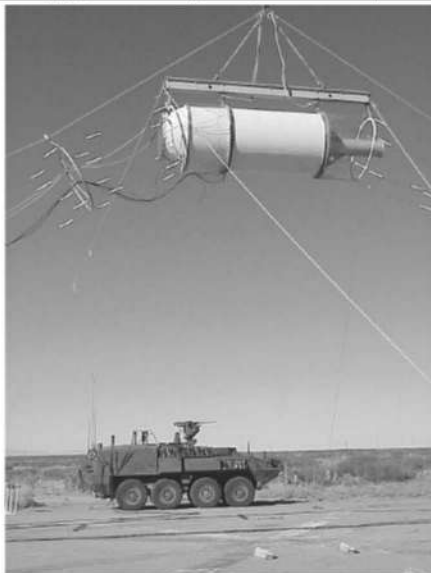
Рис. 6.7. Испытательный стенд для симуляции воздействия ЭМИ ЯВ на военную технику
