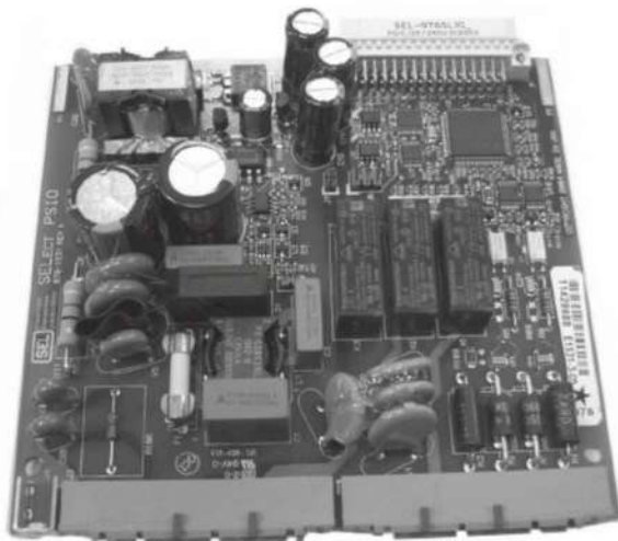
Рис. 7.4. Объединенный модуль МУРЗ, на котором центральный микропроцессор соседствует с источником питания и выходными реле
