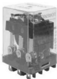
Рис. 5.24. Реле типа RMEA-FT-1 с одним замыкающим контактом с тройным разрывом, способным коммутировать постоянный ток до 3А в индуктивной нагрузке при напряжении 220В (производитель: RELEQUICK S. A.)
