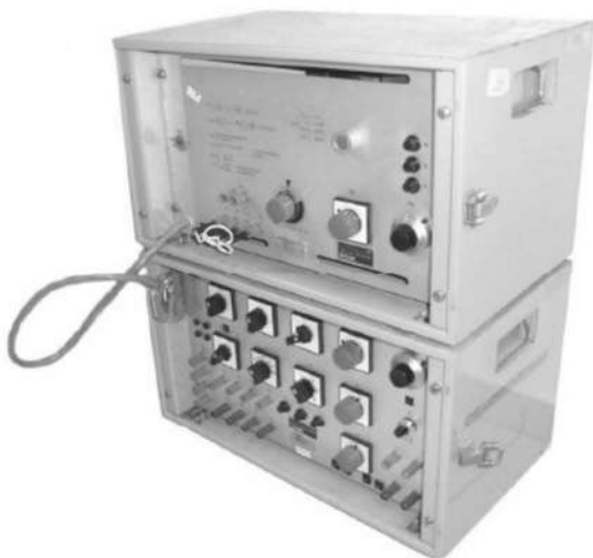
Рис. 7.9. Испытательная установка типа TURH-20 (ASEA) для проверки электромеханических реле защиты содержащая наборы индуктивностей и активных сопротивлений
