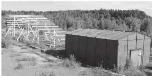
Рис. 6.8. Стационарный имитатор ЭМИ ЯВ «Аплюр» Высоковольтного научно-исследовательского центра ФГУП ВЭИ (г. Истра, Московской обл.). Габариты имитатора: 100 x 35 x 13,5 м; рабочий объем: 10 x 10 x 10 м; форма импульса: 2,5/25 нс; максимальная напряженность импульса электрического поля: 70 кВ/м
