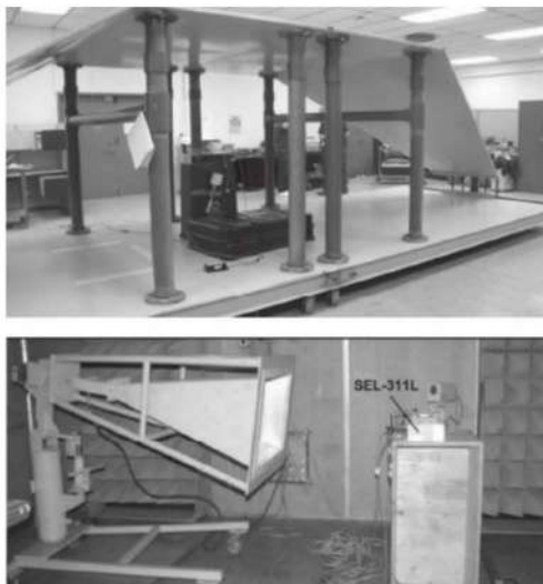
Рис. 6.14. Испытание МУРЗ типа SEL-311L на воздействие ПЭДВ на испытательных стендах полигона Пикатинни армии США в Нью-Джерси [6.20]
