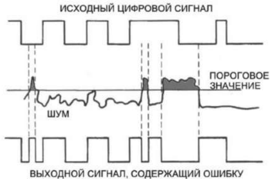
Рис. 3.1. Воздействие помехи малой энергии на работу цифрового устройства
