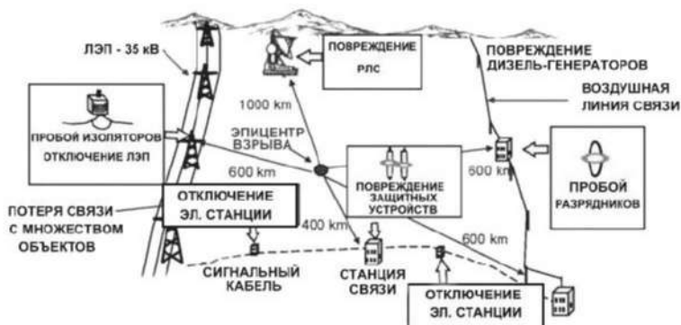
Рис. 2.1. Иллюстраций повреждений оборудования, подвергшегося воздействию высотного ЭМИ ЯВ над Казахстаном в 1962 г. Впервые рисунок был представлен на англ. языке начальником ЦНИИ-12 генерал-майором, д.т.н, профессором В. М. Лоборевым, на международной конференции EUROEM во Франции в 1994 г. [3]
