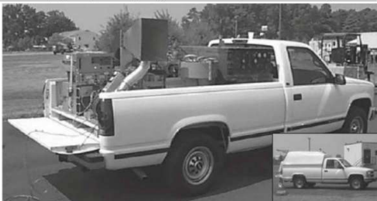
Рис. 2.23. Источник направленного сверхвысокочастотного излучения смонтированный в пикапе на базе легковушки с пластмассовым кунгом
