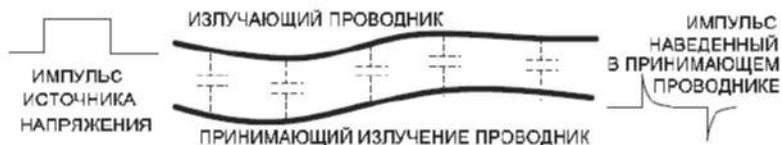
Рис. 4.35. Импульсная наводка через емкостную связь между проводниками
