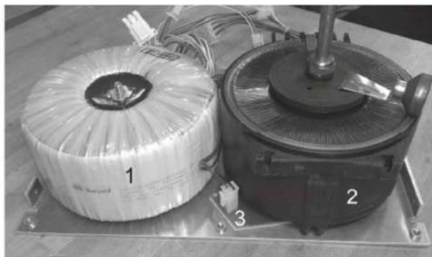
Рис. 1.46. Силовой блок устройства V10E: 1 – многообмоточный трансформатор с набором различных выходных напряжений для питания электронных узлов устройства; 2 – регулируемый автотрансформатор; 3 – плата датчика угла поворота вала автотрансформатора
