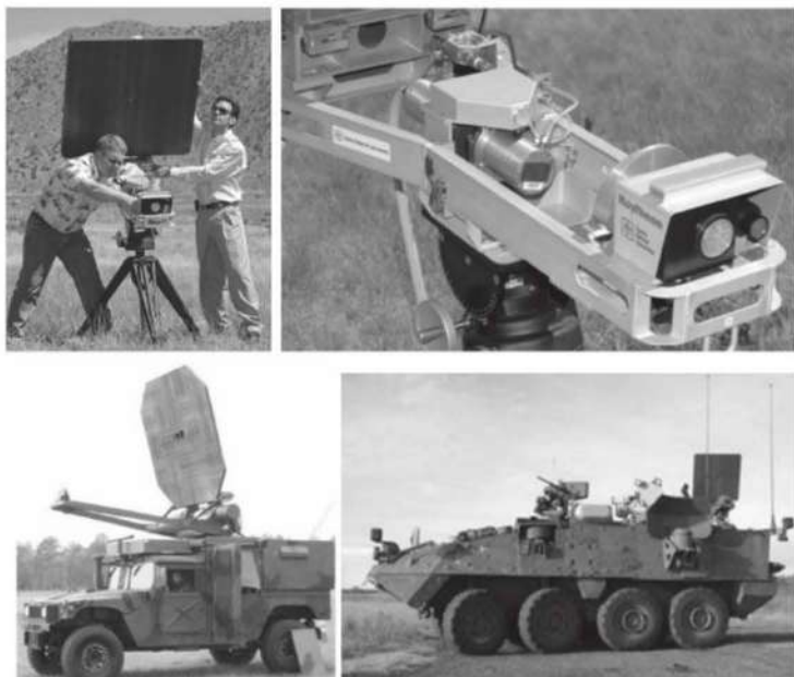
Рис. 2.16. Компактный источник мощного направленного ультракоротковолнового (95 ГГц) излучения, разработанный американской Sandia National Laboratories, с использованием технологий компании Raytheon (вверху), а также мощные источники направленного излучения, смонтированные на шасси джипа Hummer и на шасси БТР Stryker. Еще более мощный комплекс планируется установить на борту самолета AC-130
