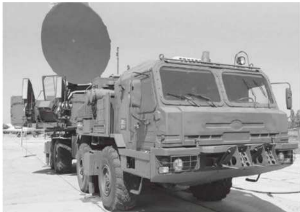
Рис. 2.18. Мобильная станция радиэлектронного подавления 1Л269 "Красуха-2"
