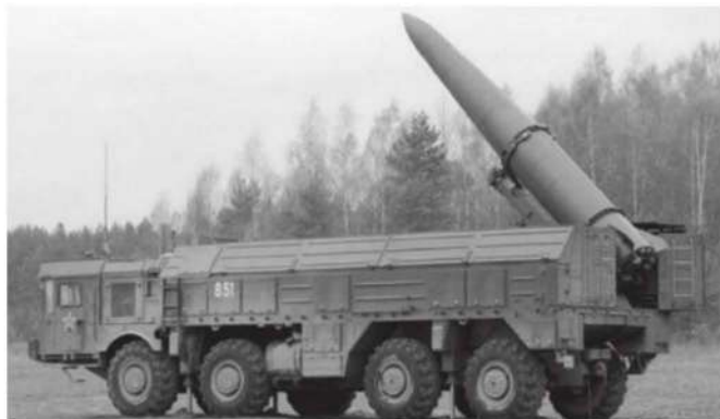
Рис. 2.3. Пусковые установки с тактической ракетой «Точка-У» (вверху) и оперативно-тактической «Искандер» (внизу)
