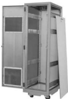
Рис. 4.1. Монтажный шкаф с усиленной защитой от ЭМИ, снабженный специальными петлями, прокладками из электропроводной резины, специальными стыковочными и соединительными элементами, экранированными вентиляционными окнами и т.д. (Equipto Electronics Corp.)
