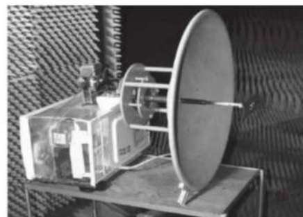
Рис. 2.22. Направленные микроволновые генераторы самодельного изготовления, описания которых приведены в популярных технических журналах
