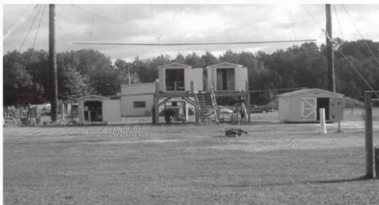
Рис. 6.18. Испытание системы SCADA на устойчивость к ЭМИ ЯВ [6.21]. Вверху видна антенная система симулятора ЭМИ. Элементы системы SCADA расположены в отдельных боксах и соединены между собой стандартной системой связи
