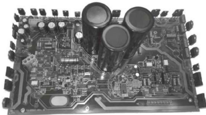
Рис. 1.4а. Электронный блок устройства В10Е. Полупроводниковые приборы, установленные по краям печатной платы, прижимаются при сборке к радиатору, которым служит корпус устройства
