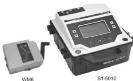
Рис. 1.9. Приборы для измерения сопротивления изоляции производства фирмы Megger: WM6 – простейший прибор с генератором и рукояткой для вращения якоря; S1-5010 – сложнейшее микропроцессорное устройство
