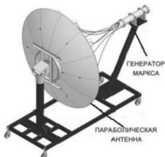
Рис. 2.14. Мощный генератор направленного микроволнового излучения на основе компактного генератора Маркса и параболической антенны
