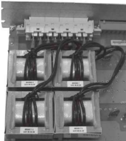
Рис. 4.42. Фрагмент модуля аналоговых входов МУРЗ с установленными ТТ. Хорошо видна первичная обмотка, состоящая из 4 витков гибкого изолированного провода черного цвета
