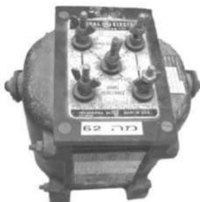
Рис. 7.8. Набор индуктивностей фирмы General Electric для проверки электромеханических реле защиты
