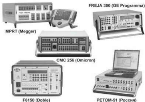
Рис. 7.10. Современные компьютеризированные тестовые системы для испытания многофункциональных микропроцессорных защит
