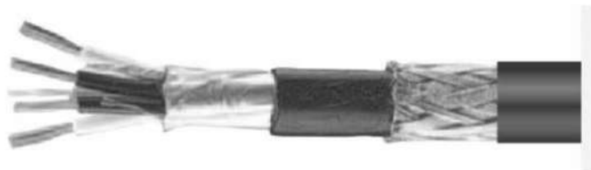
Рис. 4.40. Кабель RE-2X(ST)2Y(Z)Y PIMF, характеризующийся как сверхустойчивый к помехам (для передачи аналоговых и цифровых сигналов до 200 Кбит/сек; парная скрутка проводов с экраном из полиэстеровой фольгой для каждой пары; трехслойный общий экран из фольги и оплетки из стальной проволоки; внешняя изоляция - сшитый полиэтилен (XLPE); до 24 пар проводов в кабеле; может применяться для прокладки на открытом воздухе и в почве; обладает высокой механической прочностью)
