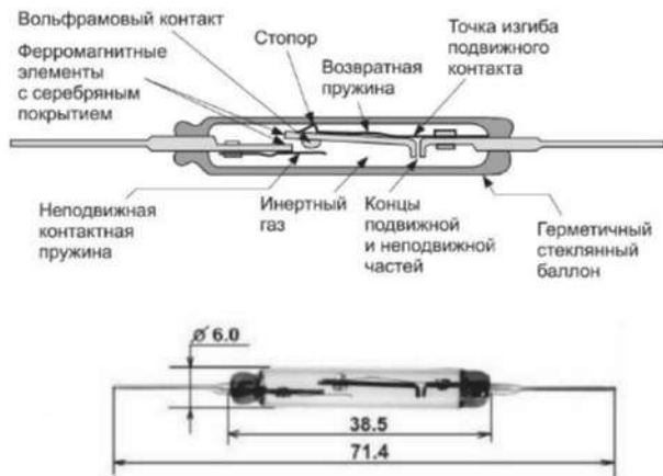
Рис. 5.3. Мощный газонаполненный геркон типа Bestact R15U фирмы Yaskawa с двустадийной коммутацией
