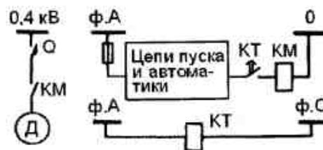
Рис. 11-2. Схема управления, обеспечивающая поочередный самозапуск особо ответственных электродвигателей после перерыва питания
