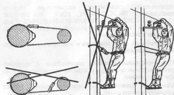
Запрещается закрепляться методом завязывания стропа вокруг конструкции.
