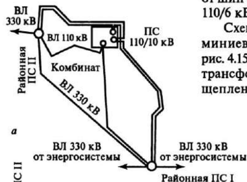
Рис. 4.13. Схема внешнего электроснабжения завода минеральных удобрений с нагрузкой 150 МВт: а – схема сети; б – схема подстанций
