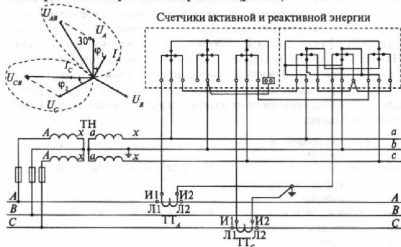
Рис. 38. Схема включения счетчика активной энергии и трехэлементного счетчика реактивной энергии в трехпроводную цепь с двумя измерительными ТТ и ТН. Прямой порядок чередования фаз ABC обязателен
