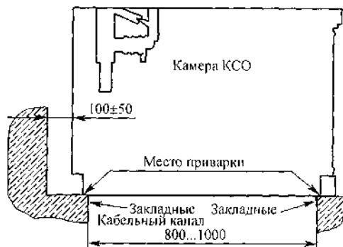
Рис. 6.8.8. Установка камер КСО-298 на закладные
