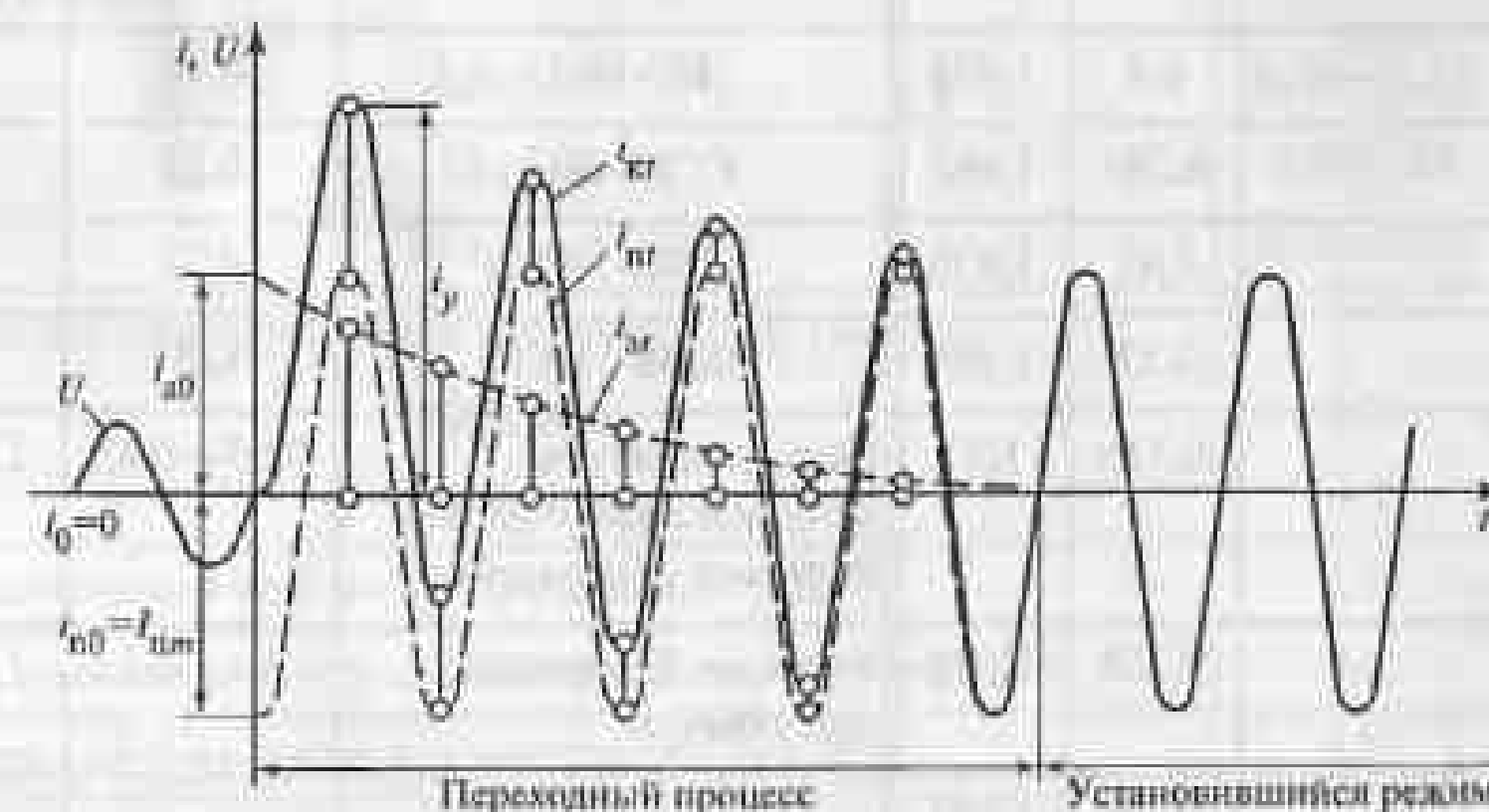
Рис. 6.3. Изменение тока КЗ в цепи, питаемой от цепи неизменного напряжения при максимальном значении аperiodической составляющей
