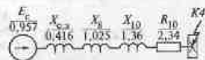
Рис. 6.17. Схема замещения для выбора сопротивления реактора по второму условию
