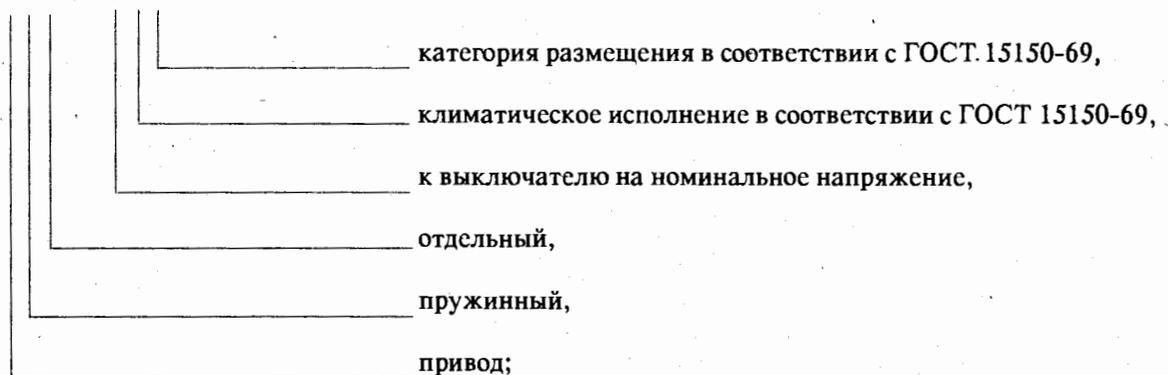
г) пример записи обозначения привода при его заказе и в технической документации привод ППО-10У2. ТУ 16. ИВКА 303446.004. ТУ-91.
