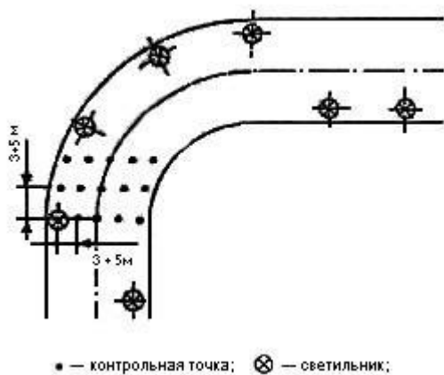
Рисунок А9 - Расположение контрольных точек при измерении средней освещенности улиц на перекрестке
