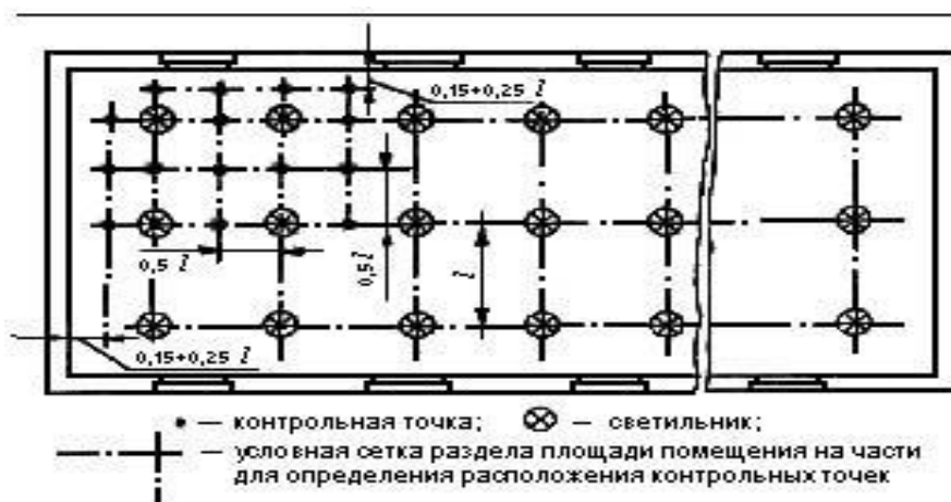
Рисунок А1 - Расположение контрольных точек при измерении минимальной освещенности помещения от светильников, принимаемых за точечные излучатели
