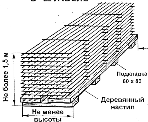
АРМАТУРНАЯ СЕТКА В ШТАБЕЛЕ
