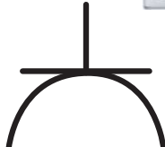
Розетка двухполюсная сдвоенная для скрытой установки, IP20-IP23
