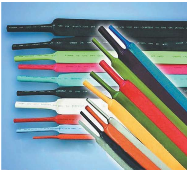
Термоусадочные трубки — это изделия из полиолефина, главным свойством которых является способность уменьшать свой диаметр (усаживаться) под воздействием высокой температуры (от 70 до 120 °С) в несколько раз. При усадке трубка плотно охватывает предмет и обеспечивает тем самым механическую или электрическую защиту.
