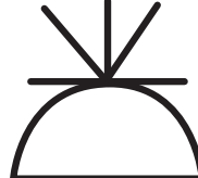
Блок: розетка + выключатель для открытой установки, IP20-IP23
