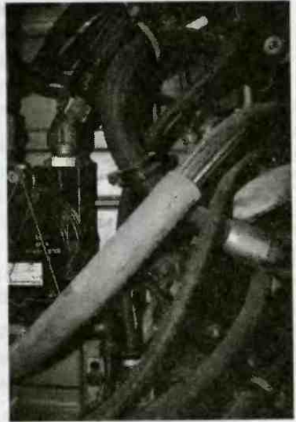
Рис. 2.8. Если провода прилегают друг к другу, допустимый ток уменьшается на 10–20 %
