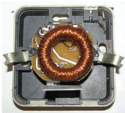
Рис. 97. Вид на диммер и элементы крепления – со снятой крышкой корпуса
