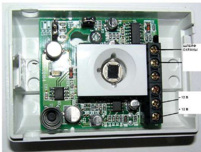
Рис. 47. Вид со снятой крышкой корпуса датчика «Фотон-9»
