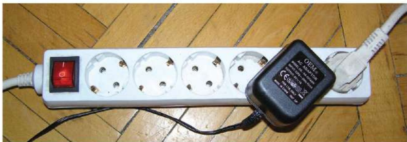
Рис. 32. Промышленный сетевой фильтр по питанию (ФП) Pilot
