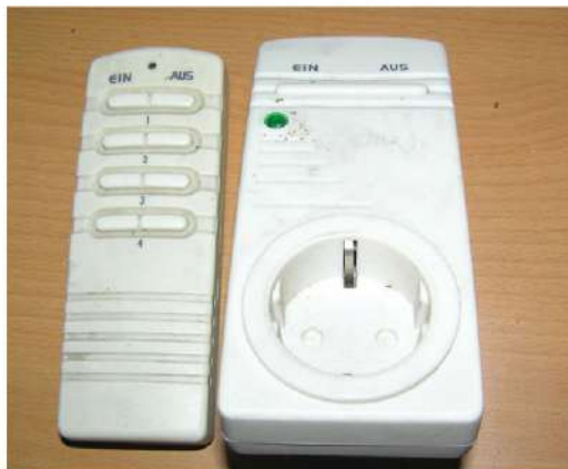
Рис. 78. Трехканальный дистанционный выключатель (по радиоканалу)
