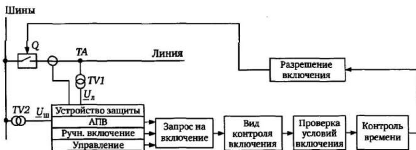
Рис. 8.12. Структура контроля напряжений и синхронизма при включении
