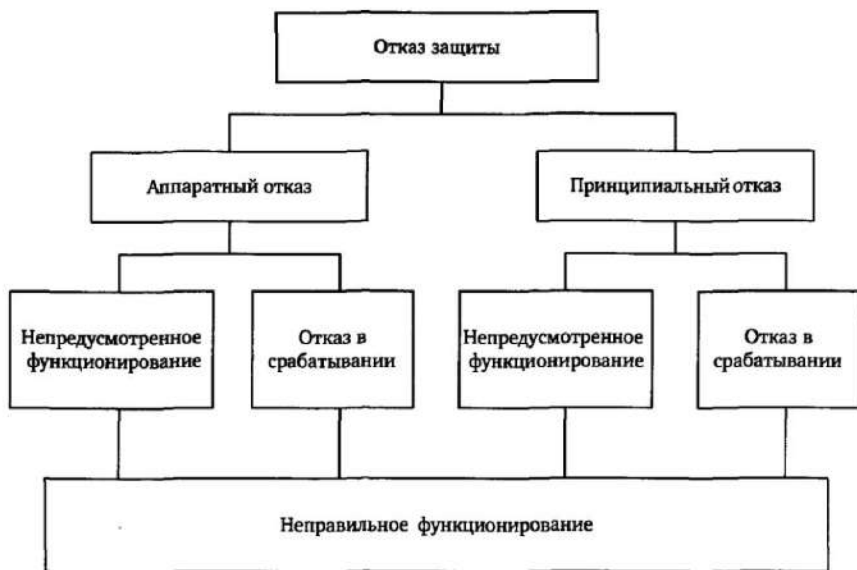
Рис. 1.15. Отказ защиты как следствие неправильного функционирования
