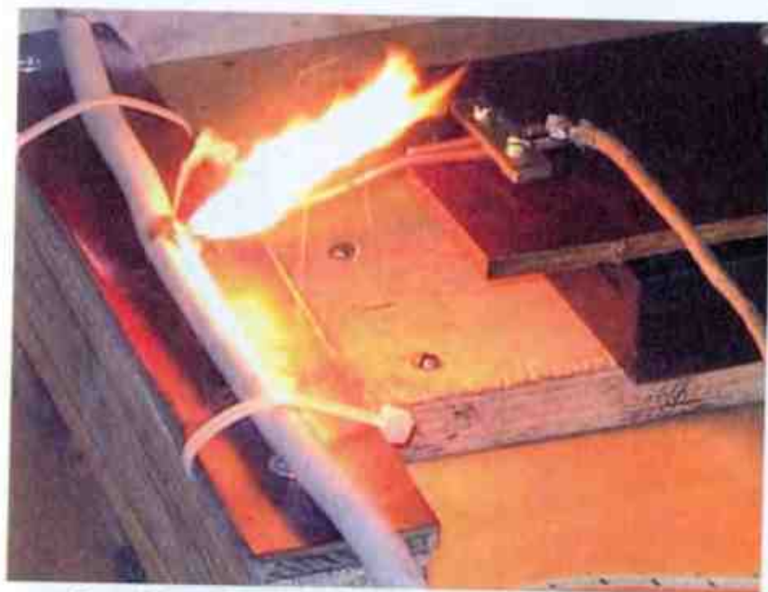
Рис. 6.22. Фрагмент эксперимента по исследованию возгорания изоляции кабеля
