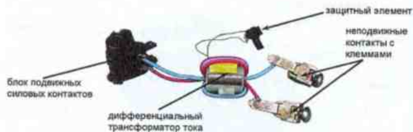
Рис. 2.50. Дифференциальный трансформатор тока двухполюсного УЗО
