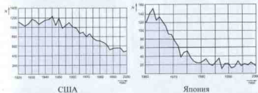
Рис. 2.6. Статистика поражений электрическим током со смертельным исходом (N) по США и Японии
