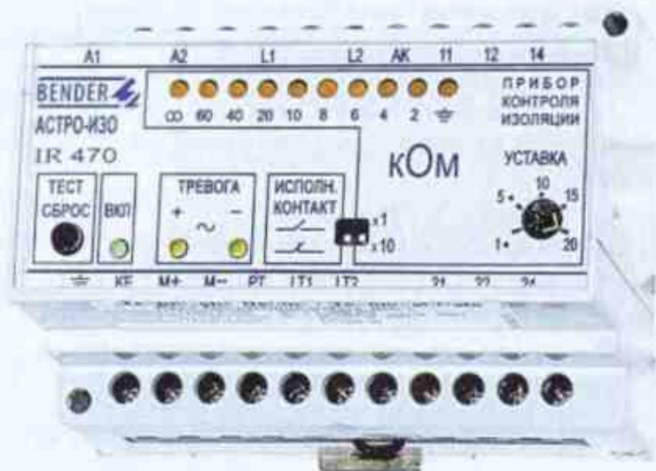
Рис. 8.1. Прибор автоматического контроля изоляции АСТРО-ИЗО-470
