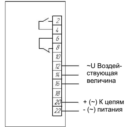
Рисунок 2 - Схема электрическая подключения реле типов РСН14, РСН 15, РСН 16, РСН 17.
