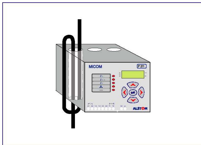
Рис. 2 Подключение MiCOM P211, когда I_n < I_b \max
